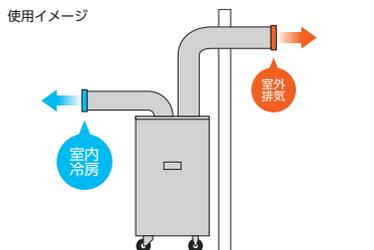
排気ダクトを排気口に接続すると、室外に排気空気を排出できます。
